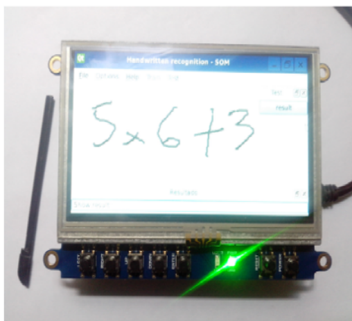
Figura 7. Plataforma de hardware del reconocimiento de símbolos escritos a mano
