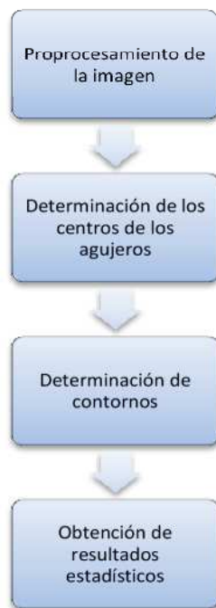
Figura 4. Diagrama de flujo del método propuesto.
