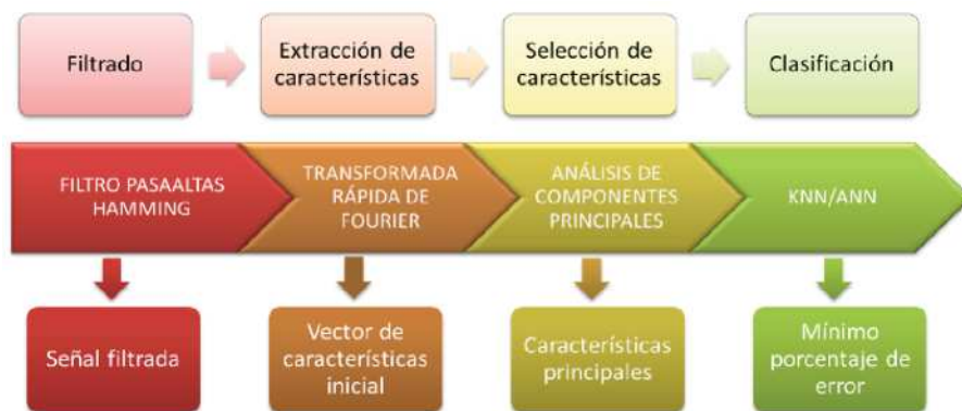
Figura 1. Esquema del enfoque propuesto para el reconocimiento de huellas acústicas.
