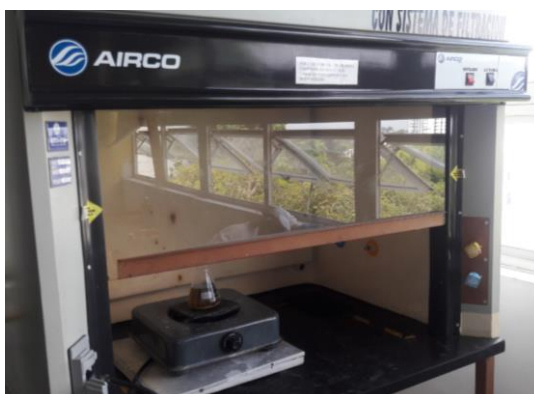
Figura 9. Cabina extractora de gases y vapores donde se realiza el proceso de evaporación de la fase acuosa de los residuos previamente precipitados.
